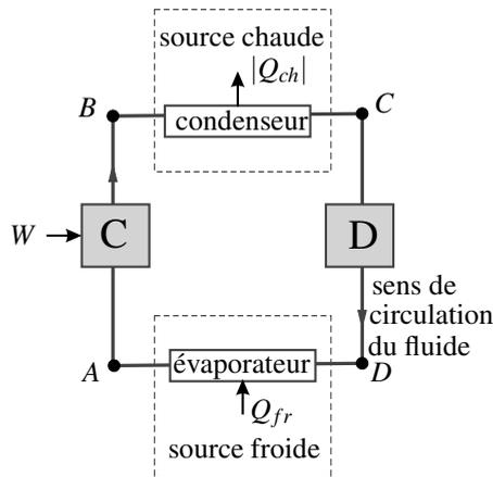
Figure 25.8 – Schéma d'un système à condensation.
