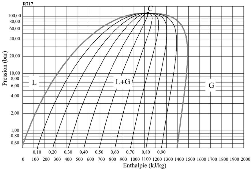
**Figure 25.10** – Diagramme des frigoristes pour l'ammoniac (fluide frigorigère R717) : isobares (horizontales), isenthalpes (verticales), courbe de saturation (en gris) et réseau d'isotitres (en noir).
