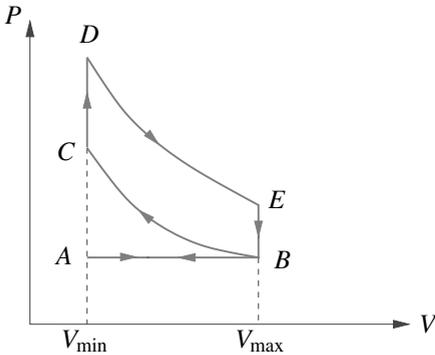
**Figure 25.5** – Cycle théorique du moteur à quatre temps.
