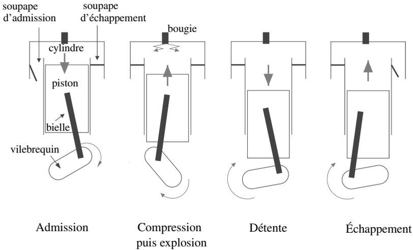
Figure 25.7 – Fonctionnement d'un moteur à 4 temps.
