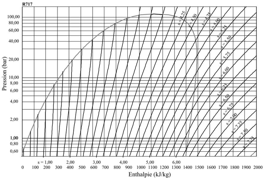
**Figure 25.12** – Diagramme des frigoris pour l'ammoniac : réseau d'isentropes. La valeur indiquée sur chaque isentrope est en  $\text{kJ}\cdot\text{K}^{-1}\cdot\text{kg}^{-1}$ . Les parties verticales des isentropes ne sont pas représentées.
