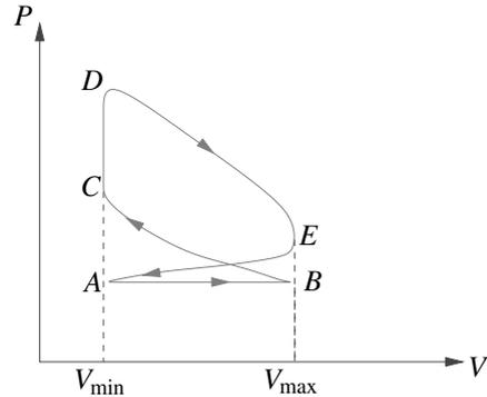
**Figure 25.6** – Cycle réel du moteur à quatre temps.
