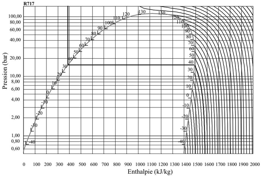
**Figure 25.11** – Diagramme des frigoris pour l'ammoniac : réseau d'isothermes. Les parties horizontales ou verticales des isothermes ne sont pas représentées par le logiciel. On a complété l'isotherme  $T = 40^{\circ}\text{C}$ .
